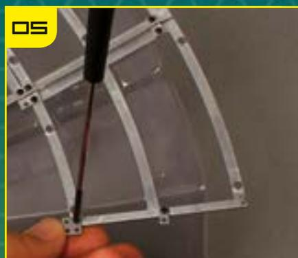
05 Закрепите соединительную накладку с четырьмя отверстиями на раме TF-19 с помощью одного винта.
