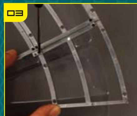
03 Зафиксируйте раму TF-19, закрутив винты в оба фланца ребра жесткости.
