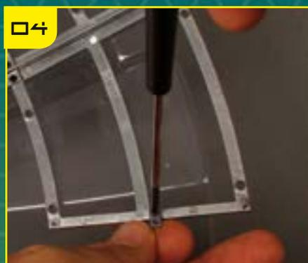
04 Закрепите соединительную накладку с двумя отверстиями в центре внешнего ребра рамы TF-19.
