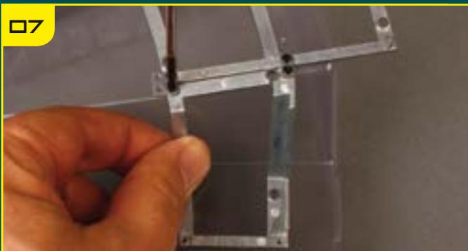
Зафиксируйте раму TF-20, закрутив винты в соединительные накладки, установленные на шагах 04 и 05.
